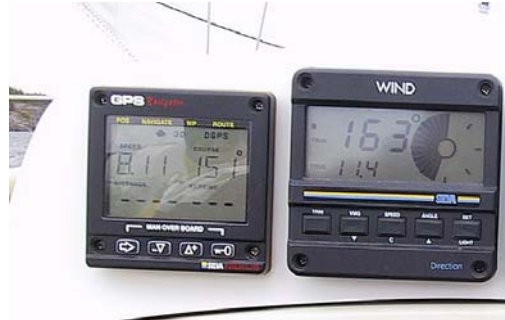
GPS fart till vänster 8.11 kn. True Wind 11.4 m/s
