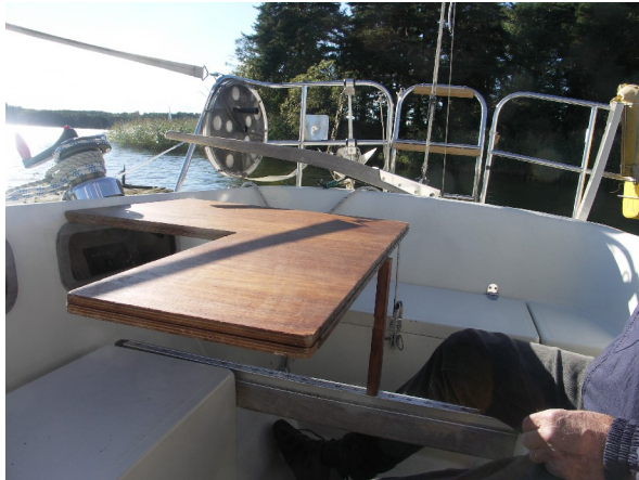
Träpinne stöder mot skotskena
