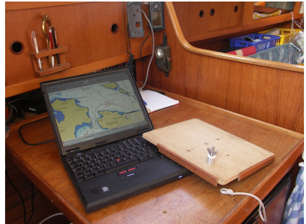
Skiva med fästbult, notera ett hål i navigationsbordet men många hål i skivan ger stor variation i positionering av datorn
