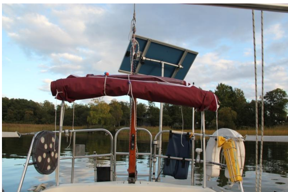
Rullen sätts upp i de två årklykefästena i aktre delen av sittbrunnssargen
